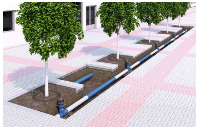
Mehrere hintereinander liegende Baumstandorte können auch von einem zentralen Punkt aus bewässert werden
