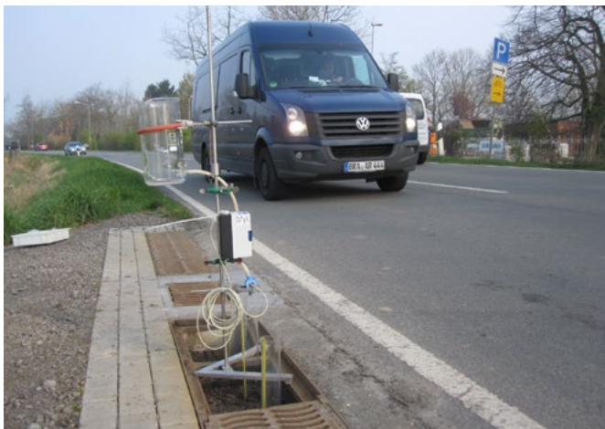
In einem Feldversuch in Lemwerder wird die D-Rainclean®-Sickermulde unter realen Bedingungen getestet
