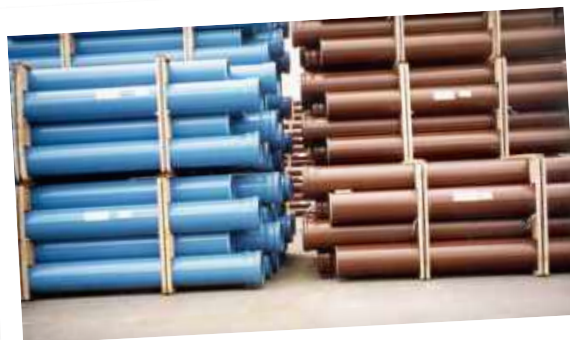
1994 HS-Kanalrohre DN/OD 250 und 300
