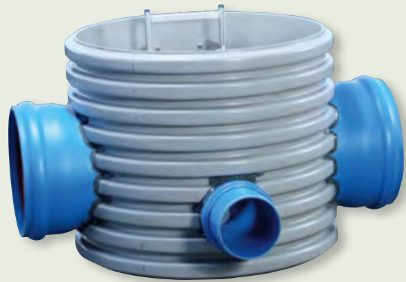
Funke Kunststoffschacht DN 1000 mit Gerinne in der Nennweite DN/OD 400 und seitlichem Zulauf DN/OD 200
