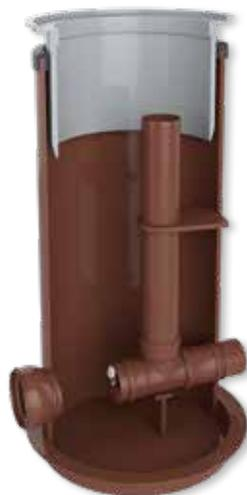
Das Dosierelement im Inneren des HS®-Drosselschachts DN/OD 800 kann auf Wunsch werkseitig eingestellt werden. Um bei einer Verstopfung des Dosierelements einen Ausfall des Systems zu vermeiden, ist direkt hinter dem Dosierelement ein Überlauf DN/OD 160 angeordnet. Der Absetzraum unterhalb des Zulaufs und des Dosierelements muss bei Bedarf mit einem Saugwagen gereinigt werden. Bei mehrlagigen D-Raintank 3000® Rigolen kommen Drosselschächte ab einer Nennweite von DN/OD 800 oder größer zum Einsatz.
