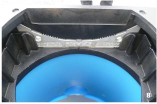
Wenn die Auflagebacken positioniert sind und fest liegen, wird das Oberteil der Konusplatte wieder so aufgelegt, dass die Zähne ineinander greifen. (8)
