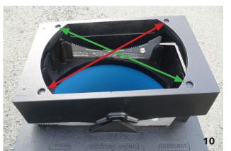
Abschließend nochmal mit je einer Hand diagonal Druck auf die Auflage ausüben. Wenn nichts wackelt und die Zähne gut ineinander greifen, ist die Einstellung o.k..
