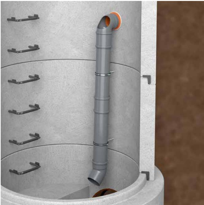
Das ILA FABEKUN®-Sattelstück mit integriertem Kugelgelenk eignet sich für den Einbau in Schächten mit einem Innendurchmesser von 700 – 2400 mm (siehe Tabelle unten) und einer Wanddicke von 30 – 245 mm. Dank des integrierten Kugelgelenks ist die angeschlossene Rohrverbindung in einem Bereich von 0° bis 13° abwinkelbar. Sonderanfertigungen von Bauteilen für andere Schachtdurchmesser oder -wanddicken sind auf Anfrage möglich.
