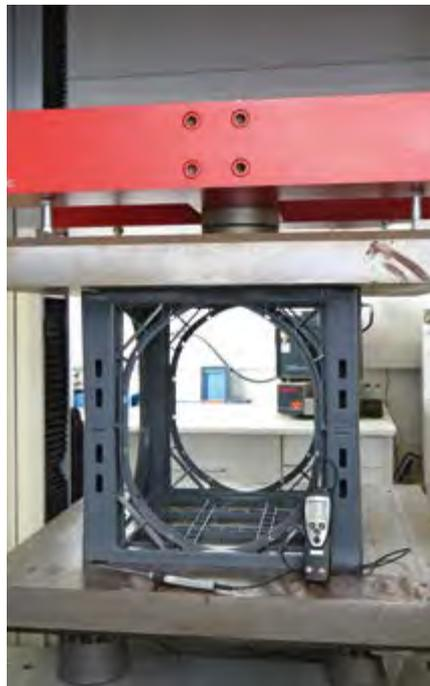
Kurzzeitversuch mit vertikaler Belastung
