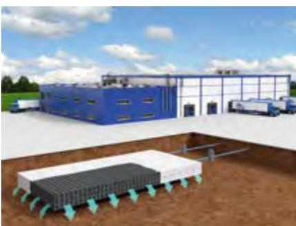
Versickerungsanlage als Dachentwässerung in Industriegebieten. Die obere Lage kann optional mit D-Raintank 3000®-Spülrohren ausgeführt werden.
