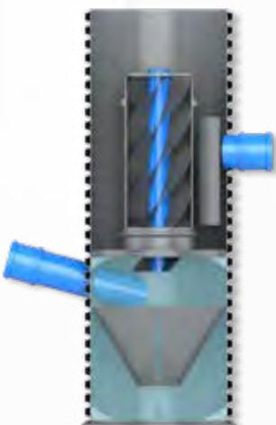
Sedimentationsschacht DN 1000
