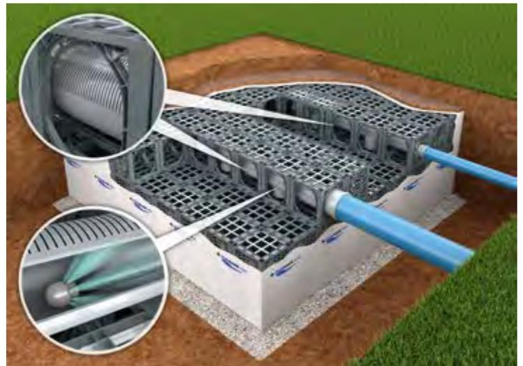
Anschluss von Rohren in den Nennweiten DN/OD 110 bis 200. Dabei ist es unerheblich, aus welcher Richtung die anzuschließende Leitung an den Rigolenkörper herangeführt wird. Ebenso können bereits hergestellte Öffnungen weiter vergrößert werden.
