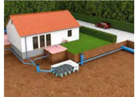
Versickerungssystem mit D-Raintank 3000® im Strang verlegt sowie mit vorgeschaltetem Reinigungsschacht und nachgeschaltetem Drosselschacht. Die Verbindungen bestehen aus HS®-Rohren für Regenwasser.
