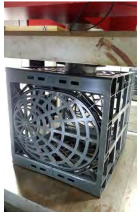
Druckbelastung der Seitenplatte über Stempel
