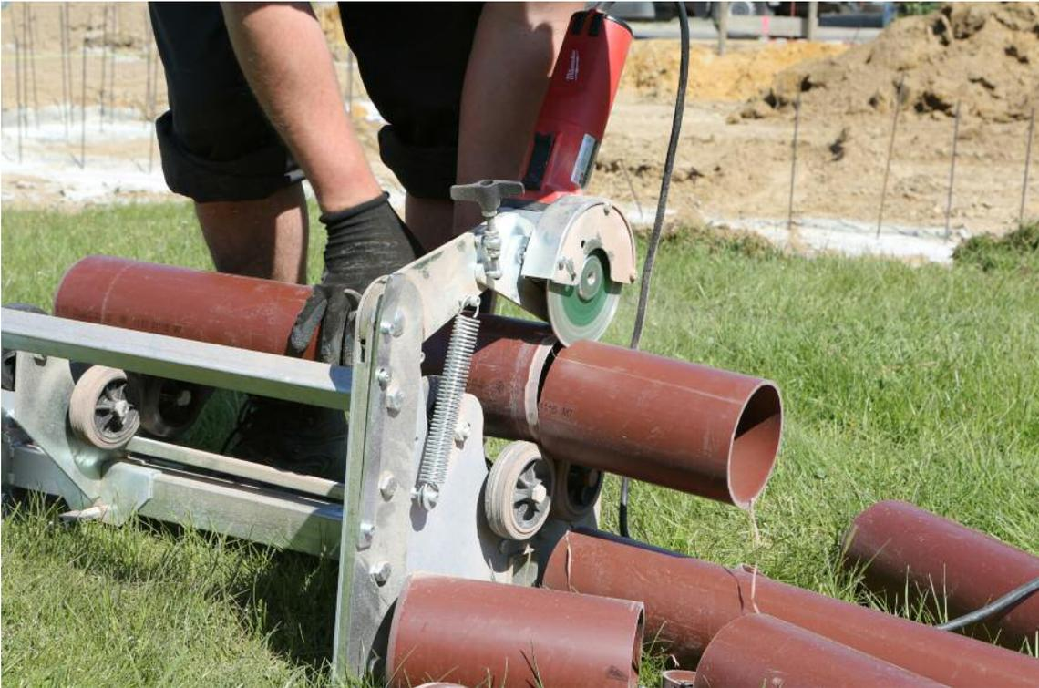
Mit dem HS®-Schneid- und Anfasgerät lassen sich Kunststoffrohre fachgerecht und schnell auf die richtige Länge bringen.
