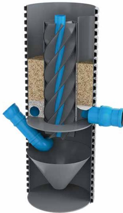
Zu den wesentlichen Bauteilen des Funke Filterschachts® zählen der tangentielle Zulauf, eine senkrecht im Schachtkörper integrierte Spirallamelle, ein Strömungstrenner, ein Filterkörper sowie ein umlaufendes Vollsickerrohr.
