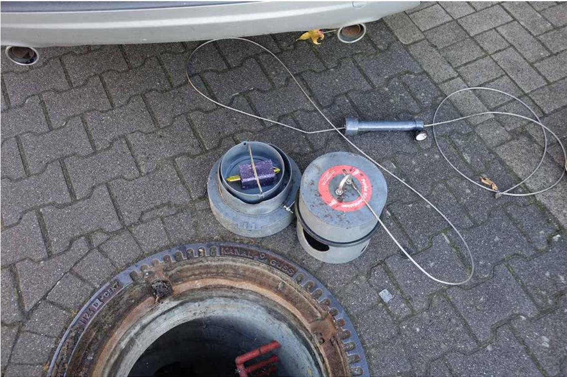
Nur noch übereinander stülpen und schon kann die Funke Köderstation eingesetzt werden. Der Köder befindet sich in einer Köderschale, die bei einem Ansteigen des Wassers im Kanal aufschwimmt.
