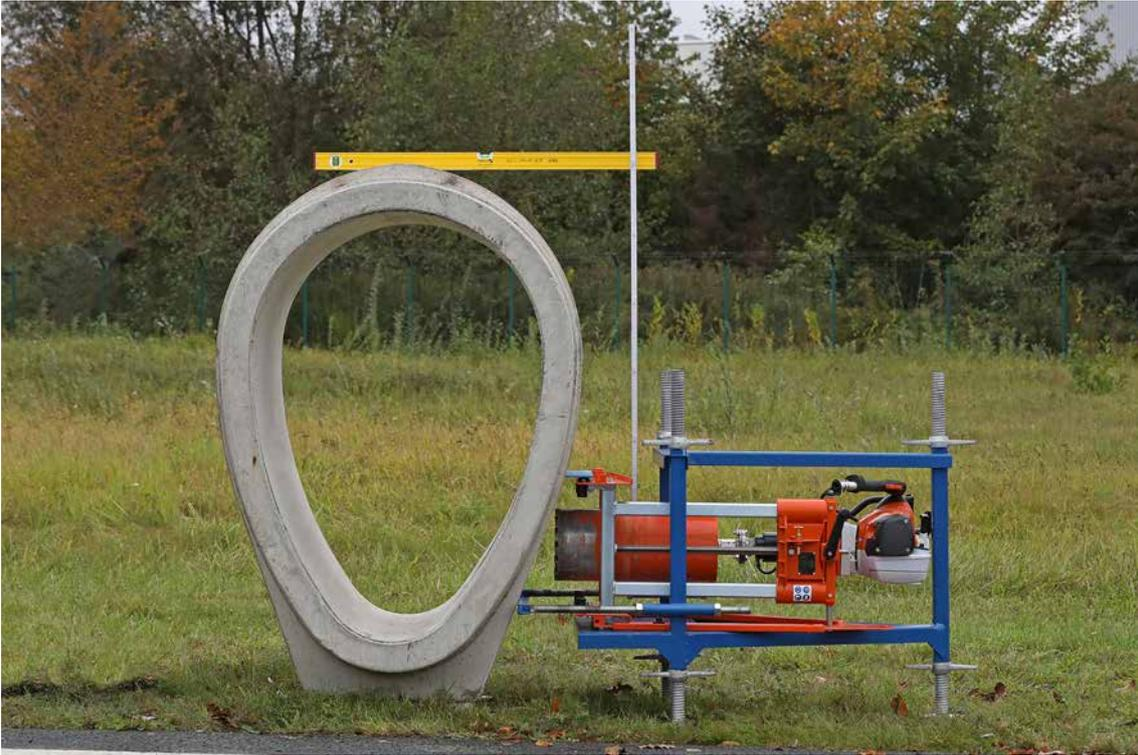
Eine ebenfalls neu entwickelte Horizontal-Bohrkonsole sorgt für die fachgerechte, rechtwinkelige und maßhaltige Erstellung der erforderlichen Kernbohrung im Eiprofil.
