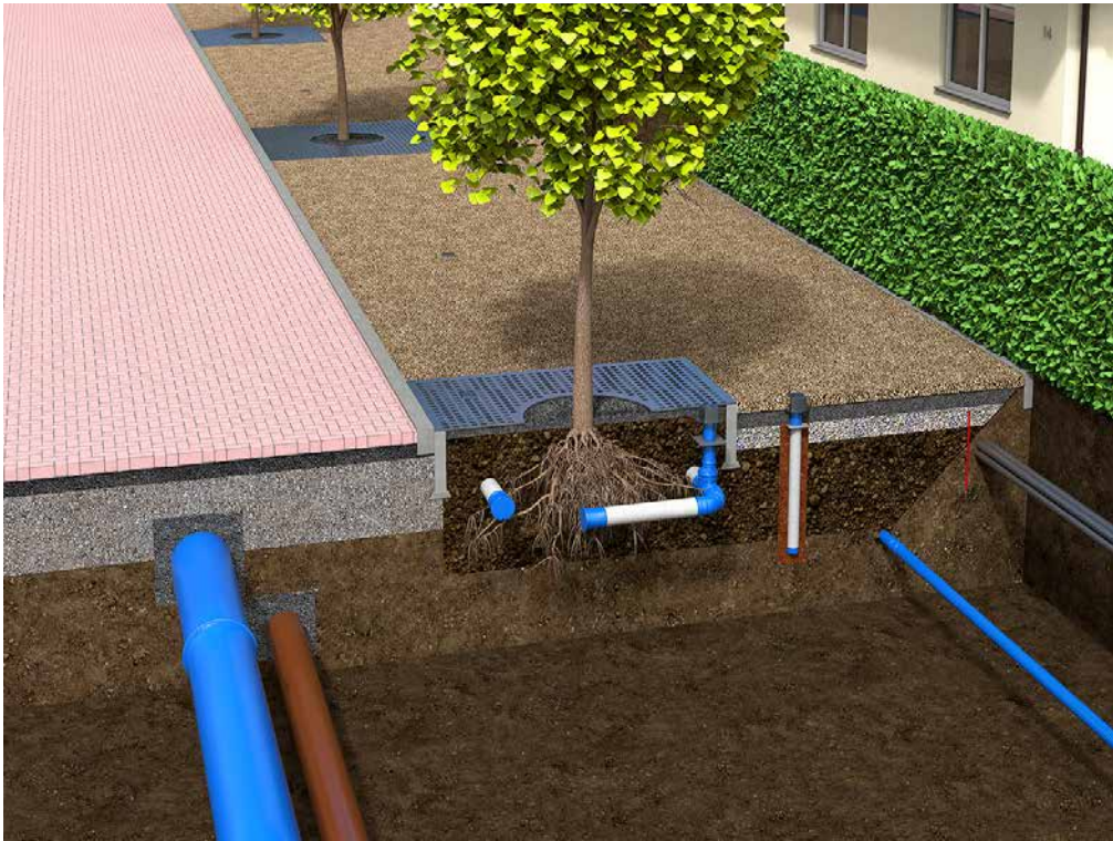
Variante mit Baumwurzelbelüfter und Baumbewässerungswinkel.
