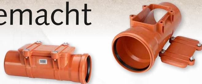
tung und einem Deckel ausgestattet, der mit vier schmutzunempfindlichen Knebelschrauben verschlossen wird. Die Schrauben aus Metalldruckguss sind so konstruiert, dass sie den Deckel nach einer 90°-Drehung freigeben – das sorgt für eine einfache Bedienung auch unter beengten Platzverhältnissen. Die verschlossene Revisionsöffnung verfügt über eine Dichtigkeit nach DIN EN 1610 (0,5 bar). Das KG-Reinigungsrohr ist in den Nennweiten DN/OD 110, 125 und 160 erhältlich.
