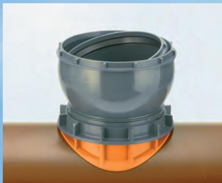
CONNEX-Anschluss DN/OD 160/162 an HS®-Kanalrohr, Bohrung 162 ± 1 mm
