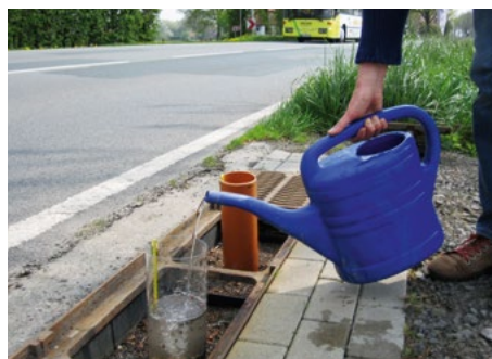
Überprüfung der Versickerungsrate
