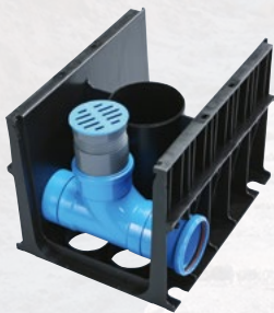
Notüberlauf-Element mit Anschluss links oder rechts DN/OD 110 Maße: 500 x 400 x 366 mm
